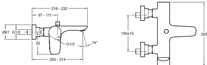
Descriptif CCTP : Mitigeur bain-douche mural. E72282. Collection : ALEO. POIDS : 2,3 kg. TYPE D'INSTALLATION : Mural. NORMES ET RÉGLEMENTATIONS : NF : IC/B - ECAU : E3/1 C2 A2 U3 (Ge3) - ACS : 10ACCLY113. DÉBIT (L/MN SOUS 3 BARS) : 20 l/mn. RACCORDS : Avec raccords et rosaces murales. MÉCANISME : Cartouche à disques céramique. ENTRAXE (MM) : 150 ± 15. MITIGEUR DE BAIN : MECANIQUE. CLAPET ANTI-RETOUR : Yes. INVERSEUR : Inverseur automatique à bouton-poussoir. GARANTIE MÉCANISME : 5 ans.
